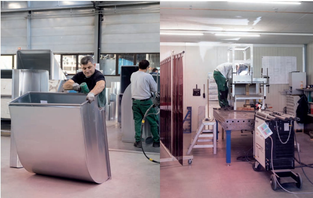
IN EINER DER DREI Werkhallen entstehen Lüftungen, wie sie in Restaurants vorzufinden sind. Die Mitarbeiter schweissen die Elemente zusammen.
